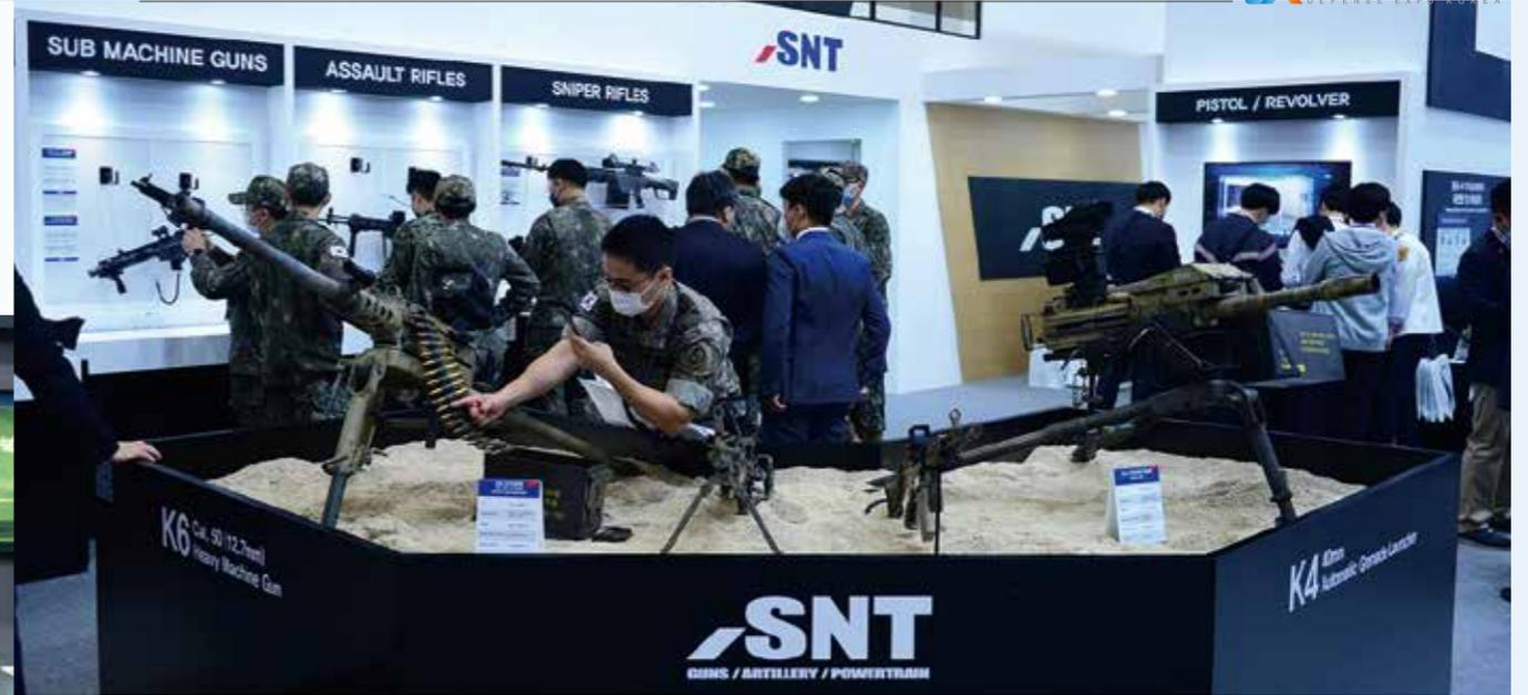
참관객이 SNT중공업에서 전시한 K6 중기관총과 SNT모티브에서 전시한 K4고속유탄기관총 등의 제품을 살펴보고 있다. K4고속유탄기관총은 K201 유탄발사기보다 뛰어난 사거리와 연사 능력을 가지고 있다. 유효사거리는 1,500m, 최대사거리는 2,200m이며, 초당 최대 6발씩 40mm 유탄을 발사할 수 있다. K6 중기관총은 중량 38kg로 발사속도가 분당 450~600발이며, 지상 유효사거리 1,830m, 공중 유효 사거리 730m, 최대사거리는 6,765m에 달한다.
