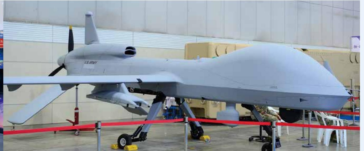
▲ 주한미군이 운용하는 MQ-1C 그레이 이글은 기존 무인항공체계보다 개선된 비행시간, 사거리, 비행고도, 장비탑재능력 등을 자랑하는 무인 정찰·공격기다. 가로 8.35m, 세로 17m, 높이 2.1m이며 무게는 1,633kg, 항속거리는 4,630km, 엔진출력은 166HP다. 헬파이어 미사일 4발이 탑재되며 직접사격과 간접사격이 가능하다. 일명 '킬러드론'으로 불린다.
