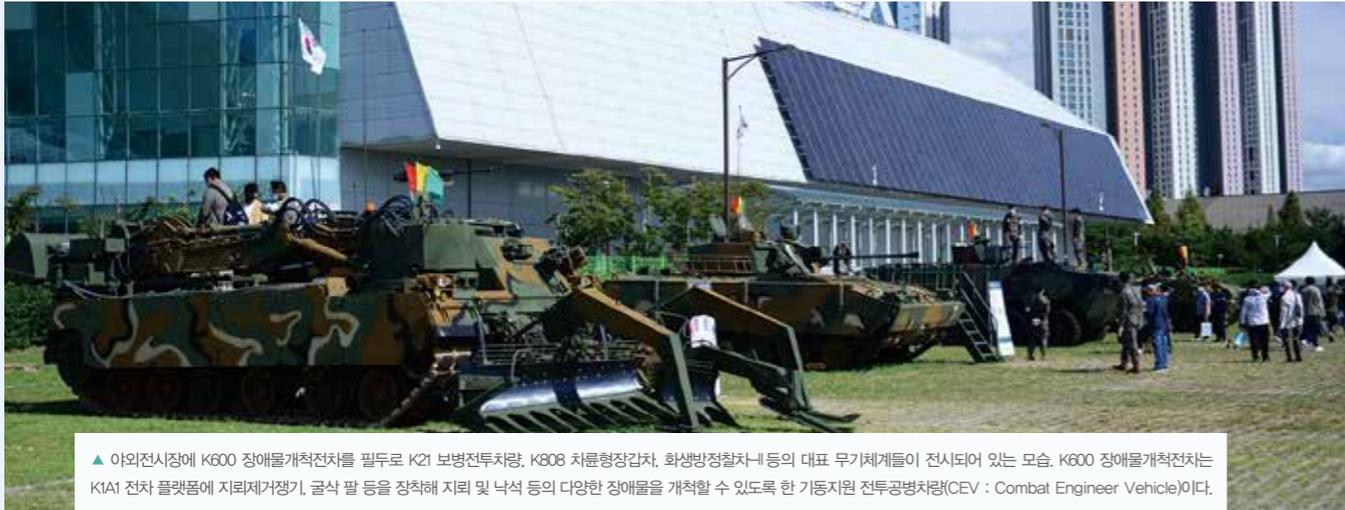
▲ 야외전시장에 K600 장애물개척전차, 필두로 K21 보병전투차량, K808 차륜형장갑차, 화생방정찰차-II 등의 대표 무기체계들이 전시되어 있는 모습. K600 장애물개척전차는 KIA1 전차 플랫폼에 지뢰제거쟁기, 굴삭 팔 등을 장착해 지뢰 및 낙석 등의 다양한 장애물을 개척할 수 있도록 한 기동지원 전투공병차량(CEV : Combat Engineer Vehicle)이다.
