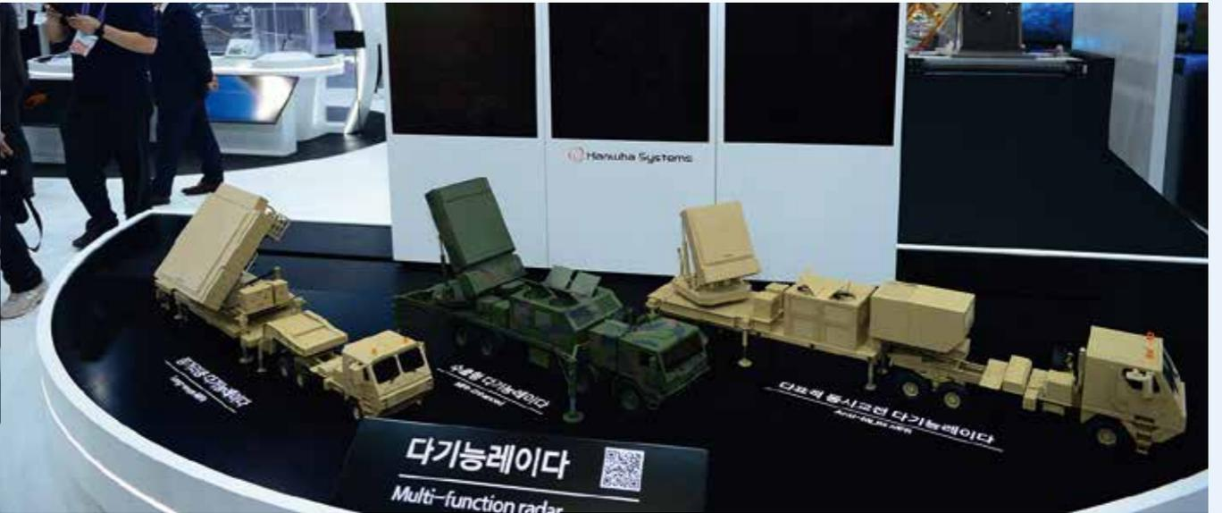
▲ 한화시스템은 지상·공중 및 우주의 모든 플랫폼간 초연결·초지능·초융합 통합 솔루션을 제시하며 첨단 방산을 이끌 미래 기술을 선보였다. 한화시스템 레이더존에 전시된 대공방어레이더 3종은 왼쪽부터 장거리용 다기능레이더, 수출용 다기능레이더, 다목적 동시교전 다기능레이더이다. 특히 천궁으로 더 잘 알려진 '중거리 지대공 유도무기체계' 다기능 레이더(MFR)의 수출용 모델은 한 개의 레이더로 전방위·다수 표적에 대해 탐지·추적·피아식별·미사일 유도 등을 수행할 수 있는 국내 최초 3차원 위상배열 다기능레이더로 해외 선진국 수준의 능동위상배열안테나(AESA)를 적용해 기술 경쟁력을 확보했다.
